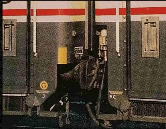
I rettangoli in giallo presenti sugli spigoli delle testate, indicano che la condotta ad Alta Tensione deve essere permanentemente collegata e alimentata.
