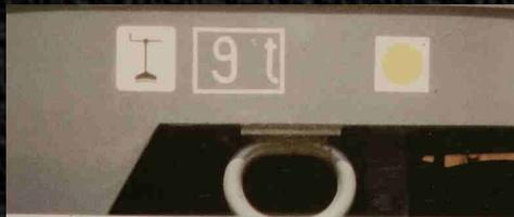
In prossimità del vestibolo troviamo l'indicazione dove è ubicato il freno a mano, il valore del suo peso frenato e il simbolo della bocchetta dell'acqua (il cerchio giallo nel quadrato bianco indica che l'acqua non gela per almeno 12 ore anche se la carrozza non è riscaldata con temperatura esterna di  $- 10\text{ C}^{\circ}$  ). Nella foto si nota anche l'anello di ancoraggio per l'imbarco sulle navi traghetto
