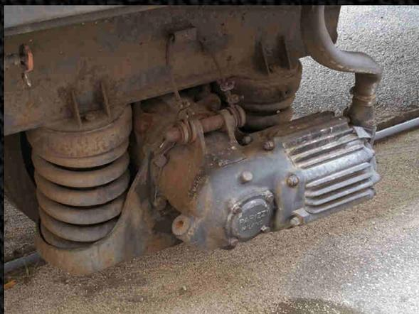
La foto sopra ci mostra un generatore dell' I.E.A. di tipo "monoblocco", applicato direttamente sulla boccola
