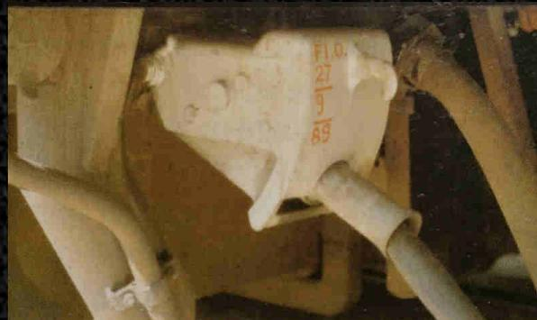
Accoppiatore "femmina" del R.E.C. con sopra il contrassegno dell'impianto che ha eseguito la prova di tensione e la data; in questo caso Firenze
