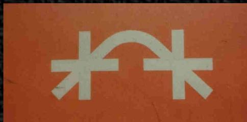
Questo contrassegno indica che il veicolo non può assolutamente circolare sulle "selle di lancio" a causa dell'ingombro delle apparecchiature sottocassa
